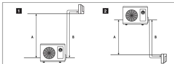
\*En el caso 2 (ud. ext. más alta) para desniveles superiores a 5~7m es necesario instalar una trampa de aceite en la tubería de gas cada 5~7m.
